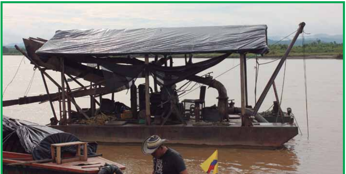
Imagen: Embarcación (draga) empleada para remoción de sedimentos desde donde se obtiene oro, río Nechí (Antioquia). Por: Ana María Castaño R
