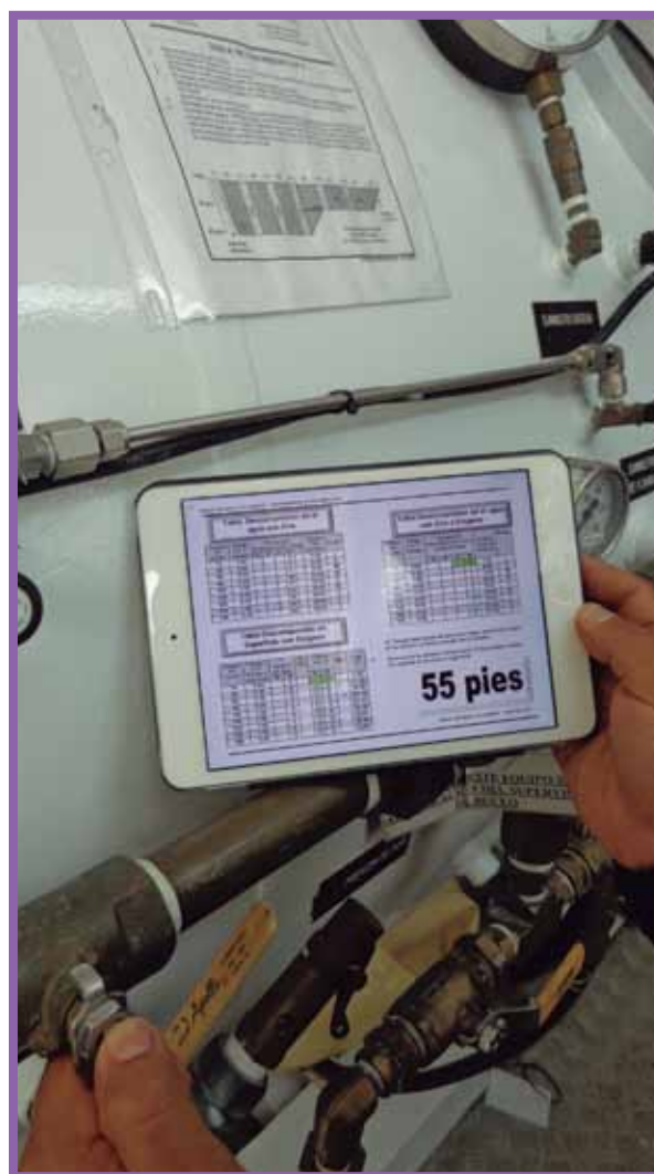
Imagen: Técnico hiperbárico, SS Arlin Quintero verificando el programa de buceo de descompresión en superficie con los datos dados por el software. Este tipo de descompresión se realiza con el apoyo de una cámara hiperbárica, propia de las actividades de buceo comercial en donde se somete artificialmente al buzo a una presión equitativa a la presión absoluta bajo el agua. Por: Buzo S2 Jairo Franco, en la estación de buceo Off Shore de Ecopetrol Coveñas.
