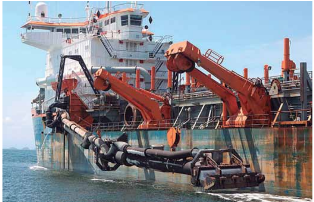
Imagen: Draga holandesa Ham 310, encargada de realizar el dragado del canal de acceso al puerto de Buenaventura. Tomada de: http://www.elpais.com.co/elpais/
