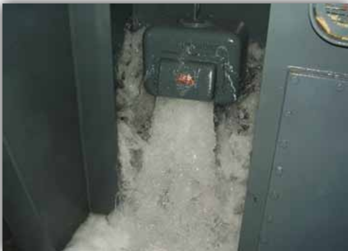
Descarga de agua de lastre, buque de tráfico internacional. Archivo Dimar.
