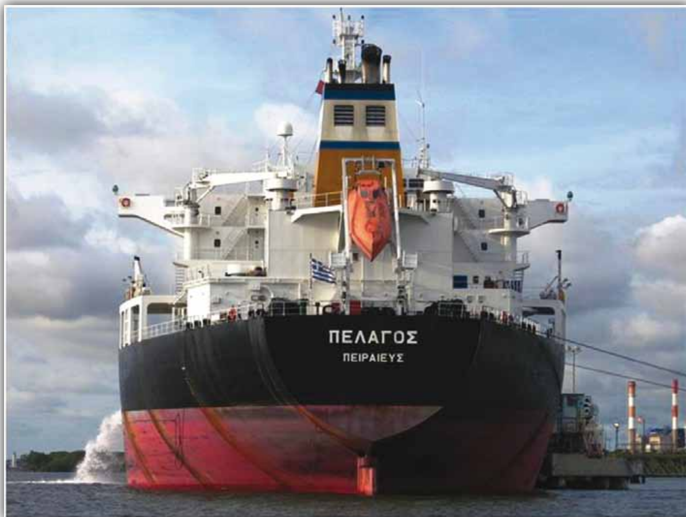
Las actividades propias de embarque de mercancía en los buques mercantes, requieren de los procesos de lastrado y deslastrado de agua, tal como se aprecia en la fotografía. Archivo Dimar.
