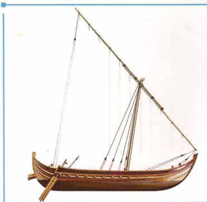
La embarcación de vela latina mediterránea de 50 pies llevaba su larga verga doble y vela triangular en un mástil inclinado hacia delante y apuntado a barlovento por unos obenques de aparejos de poleas. Se lo timoneaba con los dos remos que había a popa.
