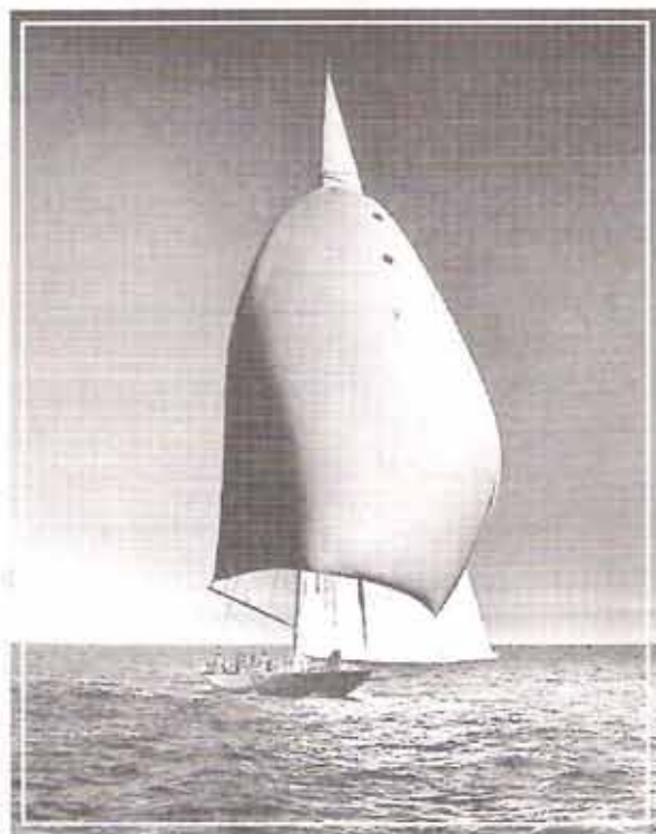
El Endeavour es impulsado por su vela balón, un tipo relativamente nuevo de vela que usó en las competiciones de la Copa América de 1934.
