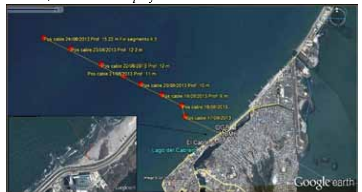
Imagen: Tendido del cable sobre la playa de Marbella y en aguas someras, hasta 15 m. de profundidad
